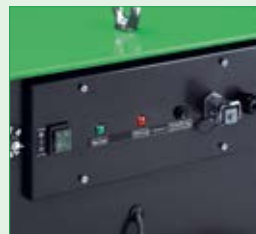
Schakel- en bedieningspa- neel bedieningsvriendelijk geplaatst
